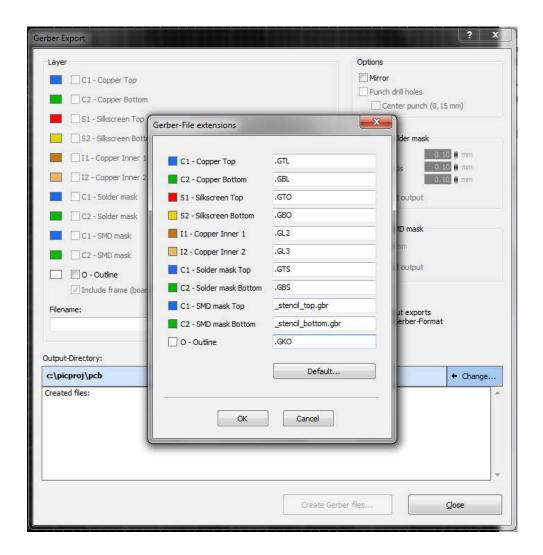
Названия для экспорта файлов трафарета для нанесения паяльной пасты остаются прежними - трафарет обычно заказывается отдельно и для его изготовления требуется всего один Gerber-файл.
