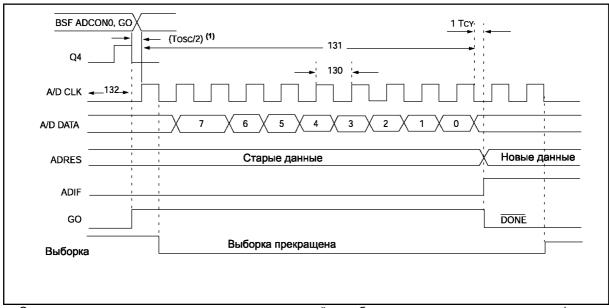
Определить время, после которого допускается перейти на более высокую скорость, можно по формуле Tcon = 1.5 Tad + N Tad + (8 – N)(2 Tosc) (где N – требуемое разрешение АЦП)
