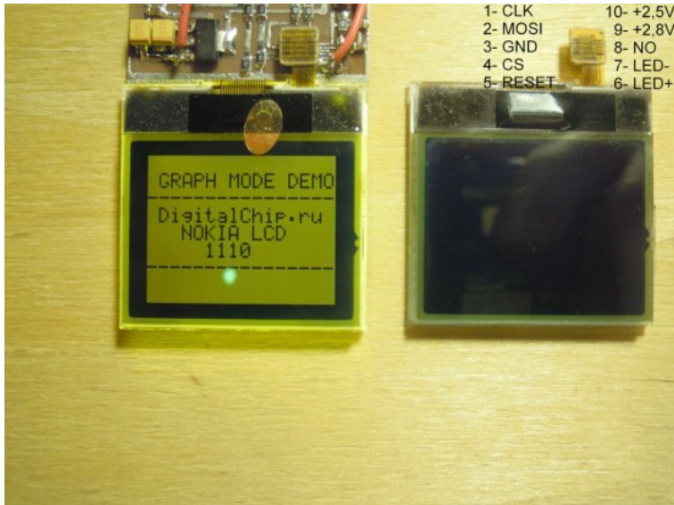
Дисплей Nokia 1202/1203/1280 – изображение немного сжато по вертикали, подсветка 3,3 в через резистор 100 Ом
