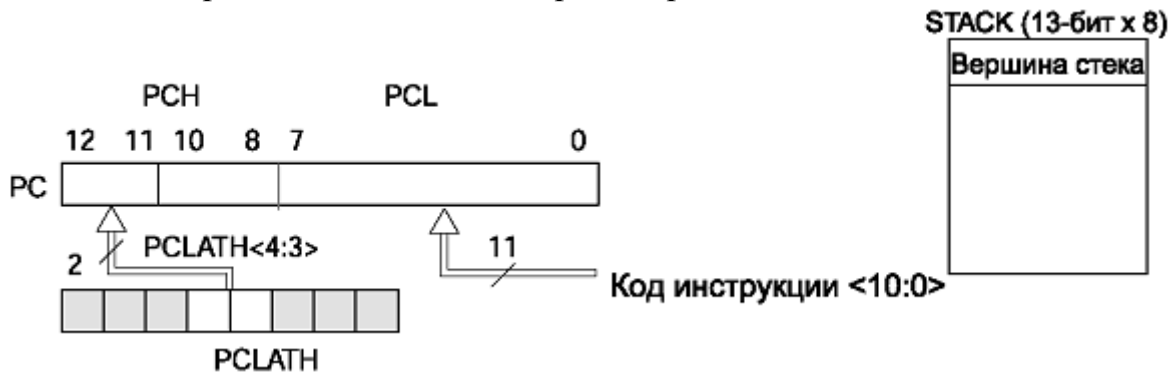
б) Изменение значения PC при выполнении инструкции GOTO ( PCLATH<4:3> \rightarrow PCH ).
