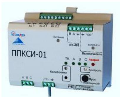
**Прибор предварительного контроля сопротивления изоляции (ППКСИ-01)** предназначен для измерения и контроля сопротивления изоляции кабельных линий трехфазной цепи в ячейках комплектных распределительных устройств класса напряжения 6-10 кВ перед включением силового высоковольтного выключателя, с подачей разрешающих/запрещающих сигналов на включение силового выключателя.
