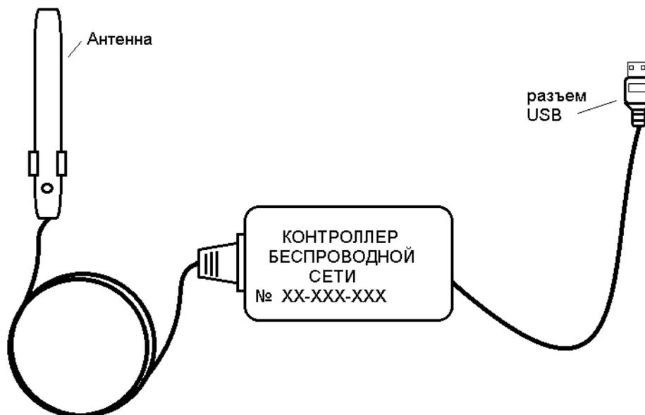
Рисунок 3 – Контроллер беспроводной сети КС-2
