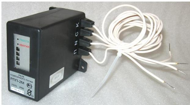
**Реле РПП-2М** предназначено для автоматического включения (повторного пуска) низковольтных (0,4 КВ) асинхронных электродвигателей после их отключения, вызванного снижением напряжения питающей сети или полным отключением напряжения (перерывом электроснабжения). Реле регистрирует информацию о количестве аварийных отключений, а также нормальных отключений электродвигателя кнопкой "СТОП". Максимальное число регистрируемых отключений - 255.
