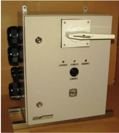
Выключатели ВРН 200 предназначены для работы в трехфазных сетях переменного тока с изолированной нейтралью в рудниках и шахтах предприятий горнорудной промышленности, не опасных по взрыву газа или рудной пыли, для защиты электрических установок от токов короткого замыкания, а также для нечастых оперативных включений и отключений электрических цепей при нормальных режимах работы трехфазных сетей.
