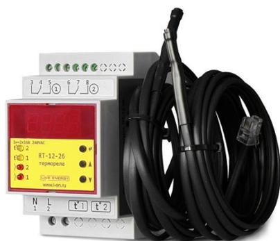
Реле температуры контролирует температурный режим в двух зонах, в пределах заданного от  $-54^{\circ}\text{C}$  до  $+125^{\circ}\text{C}$  путем включения/выключения двух нагревающих (охлаждающих) установок по сигналам выносных датчиков температуры.
