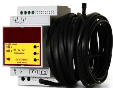
Реле температуры контролирует температурный режим в двух зонах, в пределах заданного от  $-54^{\circ}\text{C}$  до  $+125^{\circ}\text{C}$  путем включения/выключения одной нагревающей (охлаждающей) установки по сигналам двух выносных датчиков температуры.
