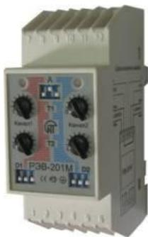
Реле предназначено для коммутации электрических цепей переменного тока 220В 50 Гц и постоянного тока 24-100 В с регулируемой выдержкой времени от 0 до 36000 с. Реле содержит два канала.
