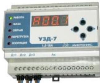
**Микропроцессорное устройство защиты двигателя УЗД-7М** предназначено для защиты трехфазных электродвигателей путем их аварийного отключения или предотвращения включения в случае обнаружения неисправности. Устройство непрерывно осуществляет контроль потребляемых двигателем токов, а также формирует предварительную команду на запрет его включения в случае пониженного сопротивления изоляции обмоток двигателя или кабеля, соединяющего магнитный пускатель с двигателем.
