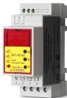
Реле контроля фаз, микропроцессорное, цифровая индикация. Регулировка нижнего и верхнего порога напряжения, гистерезиса, асимметрии, времени аварийного срабатывания и повторного включения. Контроль порядка чередования, обрыва, "слипания" фаз, обрыва нулевого провода. На DIN-рейку 35мм. 2 модуля
