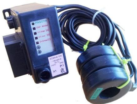
**Контроллеры КСКН-3** предназначены для программного управления в реальном масштабе времени режимными скважинами, оснащенными станками - качалками и защитного отключения электродвигателя СК при возникновении следующих аварийных ситуаций:
