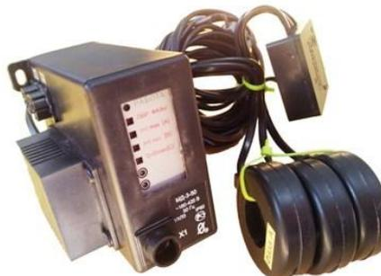
Мониторы предназначены для установки в цепях питания трехфазных электродвигателей переменного тока промышленной частоты 50 Гц напряжением 220/380 В. Широкий диапазон напряжений питания (~180 —420 В) обеспечивает возможность подключения МД к сети по схеме «фаза-ноль» или «фаза-фаза». Возможно изготовление приборов на напряжение питания ~ 110 В или другое.
