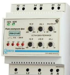
**Назначение.** Блок РКФ-3/1 предназначен для контроля напряжения трехфазной сети и защиты оборудования, в состав которого входят трёхфазные двигатели, трёхфазные источники питания постоянного тока и другие нагрузки, чувствительные к изменениям трехфазного напряжения. Обеспечивает отключение трехфазных нагрузок в случае «обрыва» фазы, нарушения чередования фаз, сильных колебаниях питающего напряжения по фазам, при аварии сети. Гарантийный срок - 2 года.
