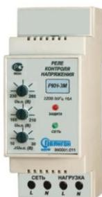
**Назначение** Реле контроля напряжения РКН-3М предназначено для защиты однофазных потребителей электроэнергии в случае выхода напряжения за установленные пороговые значения, а также для индикации режима работы блока. Отключение нагрузки осуществляется при помощи контактов внутреннего реле, выведенных на клеммную колодку. Гарантийный срок - 2 года.
