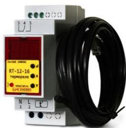
Реле температуры контролирует температурный режим в пределах заданного от  $-54^{\circ}\text{C}$  до  $+125^{\circ}\text{C}$  путем включения/выключения нагревающей или охлаждающей установки по сигналам выносного датчика температуры.
