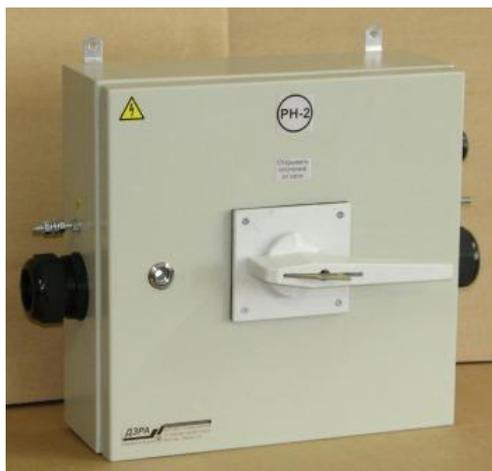
Выключатель ВАРП 250 1 У5 ТУ 3420-001-10222612-2013, выключатель автоматический в рудничном нормальном исполнении РН2, постоянного напряжения 440В, с номинальным током продолжительного режима 250А, с установленными свободными контактами, для применения в условиях умеренного климата в помещениях с повышенной влажностью.
