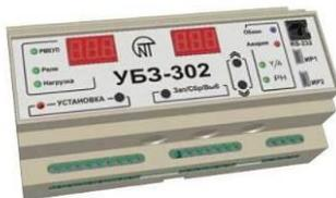
Предназначен для постоянного контроля параметров сетевого напряжения, действующих значений фазных/линейных токов трехфазного электрооборудования 380В 50 Гц и проверки значения сопротивления изоляции электродвигателей. УБЗ обеспечивает защиту асинхронных электродвигателей, мощностью от 2,5 кВт до 30 кВт при использовании встроенных токовых трансформаторов и до 315 кВт при использовании внешних токовых трансформаторов, в том числе и в сетях с изолированной нейтралью.
