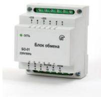
Блок обмена и передачи данных БО-01 предназначен для создания интерфейса между прибором УБЗ-301М и локальной сетью. БО поддерживает протокол MODBUS в стандарте RS-485. БО принимает данные, регулярно передаваемые УБЗ, и записывает их в свои внутренние регистры.
