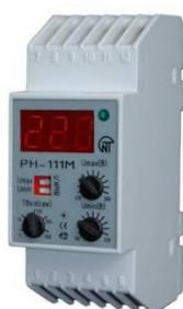
предназначено для отключения бытовой и промышленной 1-фазной нагрузки 220 В, 50 Гц любой мощности при недопустимых колебаниях напряжения в сети с последующим автоматическим включением после восстановления параметров сети:
