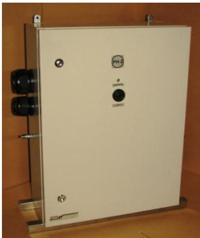
Пускатели электромагнитные рудничные ПРН 63А 1 С 29 У5 ТУ 3420-003-10222612-2013, пускатель в рудничном нормальном исполнении РН2, переменного напряжения 380В, с номинальным током продолжительного режима 63А, на салазках, с тепловым реле на 56А, для применения в условиях умеренного климата в помещениях с повышенной влажностью.
