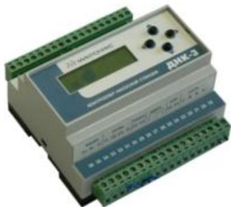
ДНК-3 предназначен для управления двухнасосной канализационной станцией (КНС) в автоматическом режиме. ДНК-3 полностью заменяет ранее выпускавшийся для этой же цели ДНК-2. По сравнению с ДНК-2 у ДНК-3 изменился внешний вид, добавились входы ручного управления и проверки изоляции, появилась возможность дистанционного управления насосами, введены пробные пуски долго не включавшихся насосов.
