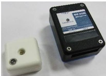
Фотореле предназначено для автоматического включения и отключения освещения в составе систем управления. Устройство использует освещенность датчика для управления внутренним реле. Контроль осуществляется по свечению двухцветного светодиода. Свечение любым цветом сигнализирует о подаче питающего напряжения 220 В. Свечение зеленым цветом сигнализирует о яркой засветке датчика, контакты реле разомкнуты. Свечение красным цветом сигнализирует о отсутствии засветки датчика, контакты реле замкнуты.
