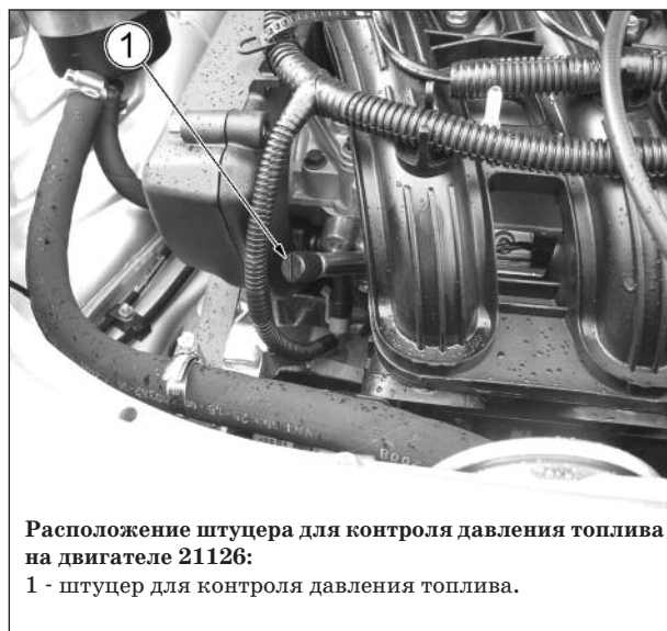
Расположение штуцера для контроля давления топлива на двигателе 11183:
