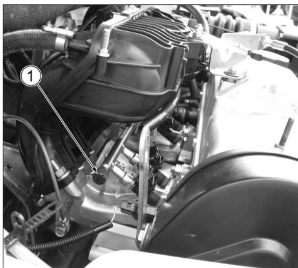
Расположение штуцера для контроля давления топлива на двигателе 11183:
