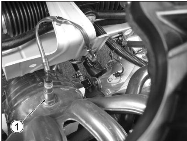
Рис. 1.1-09. Расположение управляющего датчика кислорода в подкапотном пространстве автомобилей семейств LADA PRIORA и LADA KALINA: 1 - управляющий датчик кислорода.
