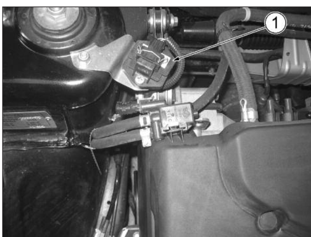
Рис. 1.1-16. Расположение датчика неровной дороги в подкапотном пространстве автомобилей семейства LADA PRIORA: 1 - датчик неровной дороги.
