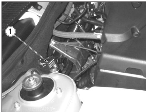
Рис. 1.1-17. Расположение датчика неровной дороги в подкапотном пространстве автомобилей семейства LADA KALINA:
