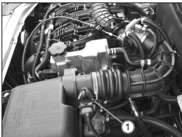
Рис. 1.1-03. Расположение датчика массового расхода воздуха в подкапотном пространстве автомобилей семейств LADA PRIORA и LADA KALINA:
