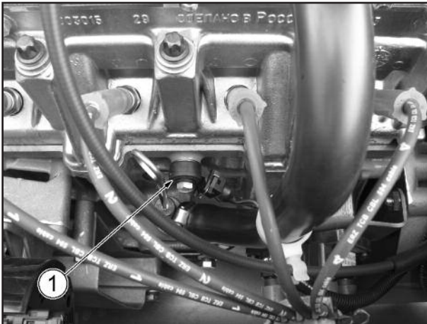
Рис. 1.1-08. Расположение датчика детонации на двигателе 11183: 1 - датчик детонации.
