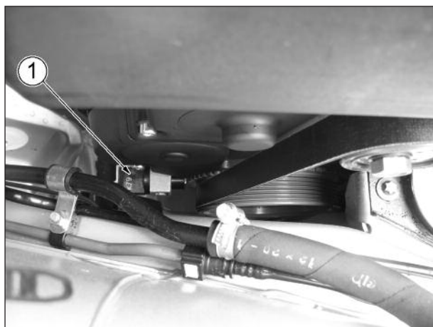
Рис. 1.1-12. Расположение датчика положения коленчатого вала в подкапотном пространстве автомобилей семейства LADA PRIORA: 1 - датчик положения коленчатого вала.
