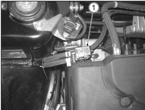
Рис. 1.8-02. Расположение клапана продувки адсорбера на автомобилях семейства LADA PRIORA: 1- клапан продувки адсорбера.
