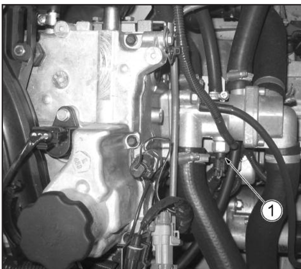
Рис. 1.1-05. Расположение датчика температуры охлаждающей жидкости в подкапотном пространстве автомобилей семейства LADA PRIORA (при снятом воздушном фильтре):
