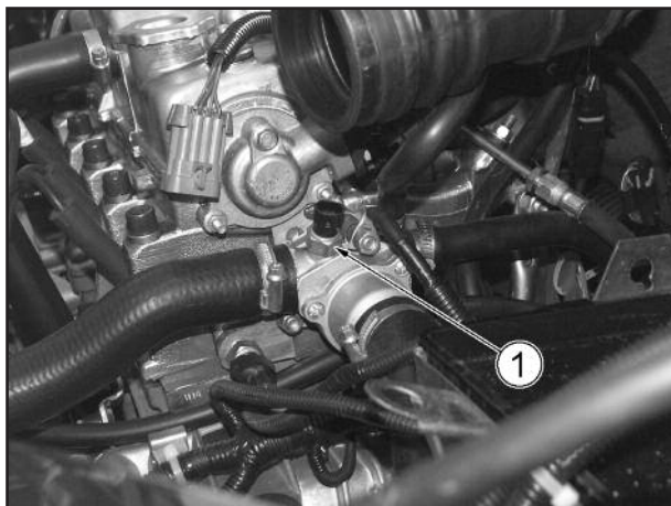
Рис. 1.1-06. Расположение датчика температуры охлаждающей жидкости в подкапотном пространстве автомобилей семейства LADA KALINA (при снятом воздушном фильтре):
