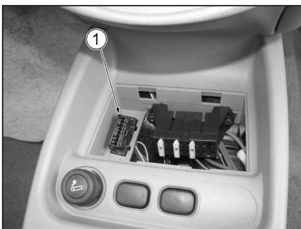
Рис. 2.3-02. Расположение колодки диагностики в салоне автомобилей семейства LADA KALINA:
