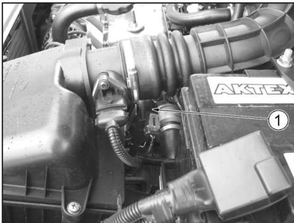
Рис. 1.8-03. Расположение клапана продувки адсорбера на автомобилях семейства LADA KALINA: 1- клапан продувки адсорбера.
