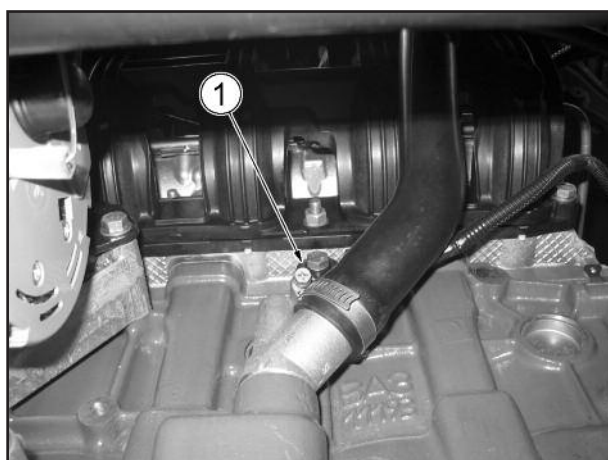
Рис. 1.1-07. Расположение датчика детонации на двигателях 21126, 11194:
