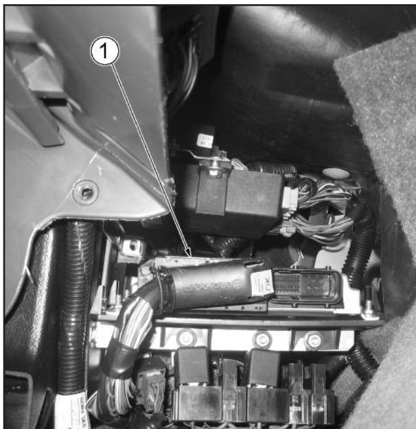
Рис. 1.1-01. Расположение контроллера в салоне автомобилей семейства LADA PRIORA: 1 - контроллер.
