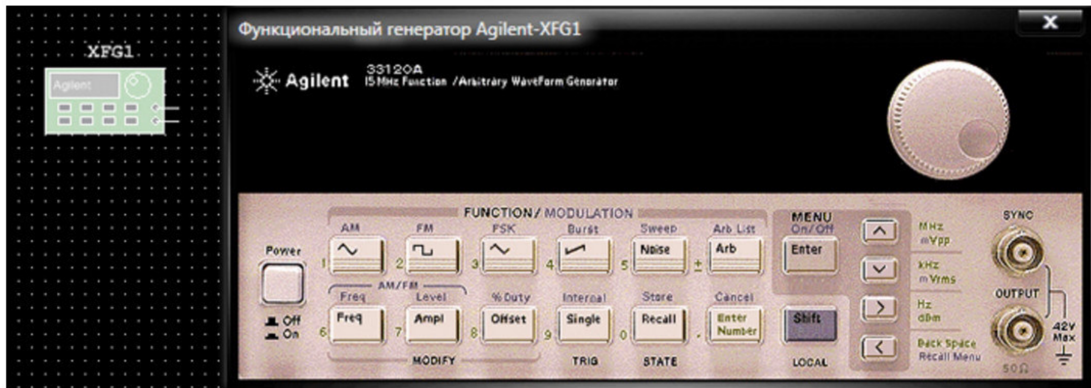
Рис. 1. Лицевая панель функционального генератора Agilent и его пиктограмма на схеме
