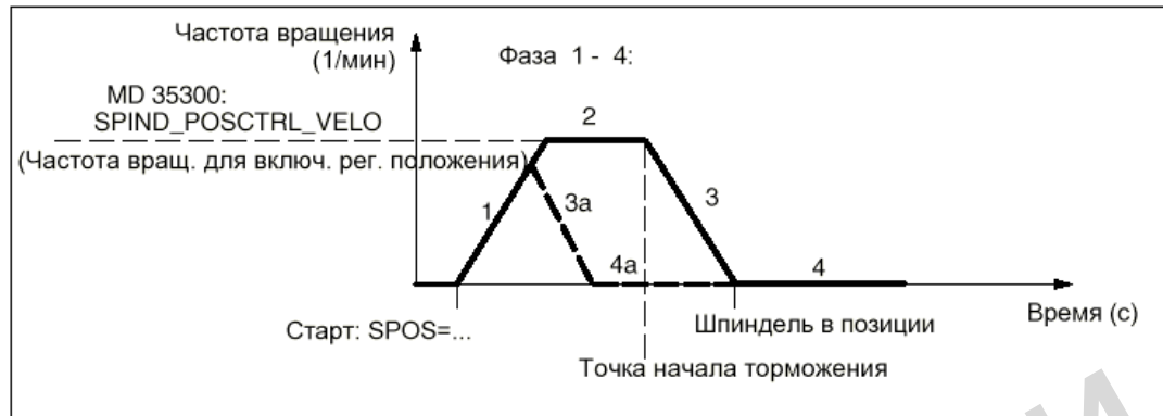
Рис. 5-5 Позиционирование синхронизированного шпинделя из состояния покоя
