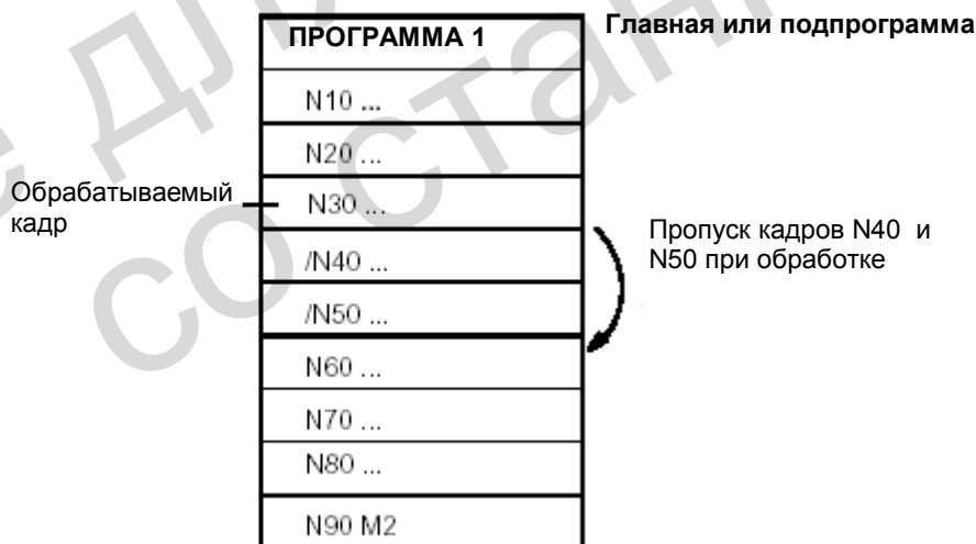
Рис. 10-3 Селекция кадров программы обработки детали
