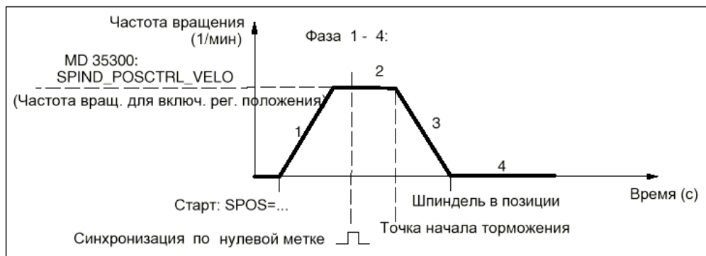
Рис. 5-4 Позиционирование не синхронизированного шпинделя из состояния покоя
