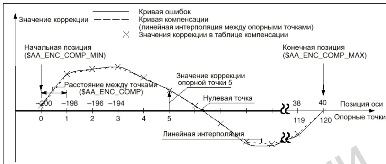
Рис. 16-3 Параметры таблицы компенсации (системные переменные для SSFK)
