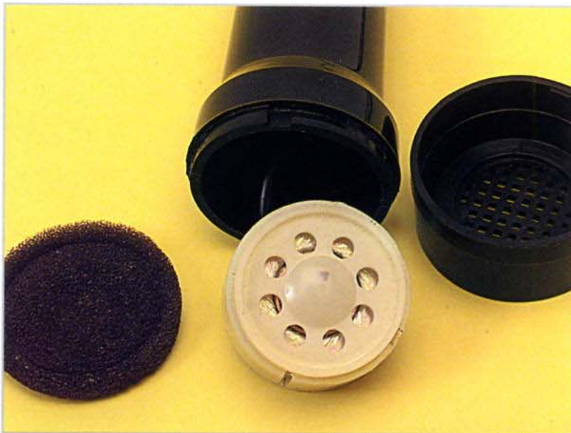
Microfono dinamico: si vede la capsula microfonica.
