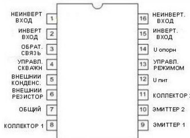
Микросхема помещена в пластиковый (на это указывает литера N в конце ее обозначения) 16-контактный корпус с выводами пdf-типа.
