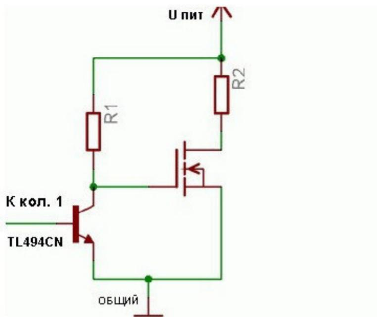
Мощный МОП-транзистор в этой схеме управляетя в пассивном режиме. Это не очень хорошо, но для целей тестирования и малой мощности вполне подходит. R1 в схеме является нагрузкой прп-транзистора. Выберите его в соответствии с максимально допустимым током его коллектора. R2 представляет собой нагрузку нашего силового каскада. В следующих экспериментах он будет заменен трансформатором.
