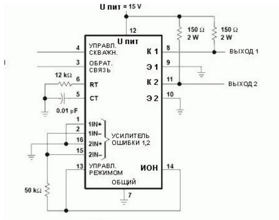
Если все подключено правильно, то схема будет работать. Оставьте выводы 3 и 4 не свободными. Используйте свой осциллограф, чтобы проверить работу ГПН – на выводе 6 вы должны увидеть пилообразное напряжение. Выходы будут нулевыми. Как же определить их работоспособность в TL494CN. Проверка ее может быть выполнена следующим образом:
