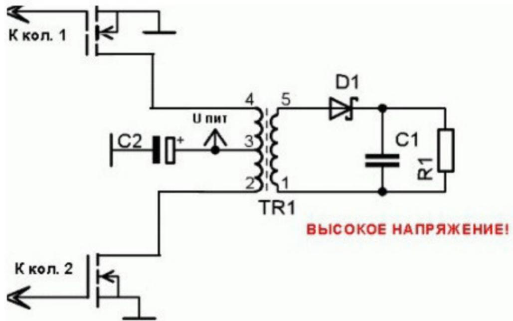
Первичная обмотка трансформатора содержит 10 витков. Вторичная обмотка содержит около 100 витков. Таким образом, коэффициент трансформации равен 10. Если подать 10В в первичную обмотку, вы должны получить около 100 В на выходе. Сердечник выполнен из феррита. Можно использовать некоторый среднего размера сердечник от трансформатора блока питания ПК.
