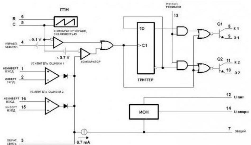
Микросхема имеет встроенный источник опорного напряжения (ИОН) +5 В (№ 14). Он обычно используется в качестве эталонного напряжения (с точностью  $\pm 1\%$ ), подаваемого на входы схем, потребляющих не более 10 мА, например, на вывод 13 выбора одно- или двухтактного режима работы микросхемы: при наличии на нем +5 В выбирается второй режим, при наличии на нем минуса напряжения питания – первый.
