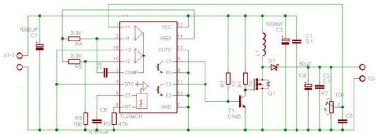
На ней можно увидеть схему включения микросхемы и выходной каскад на двух транзисторах: универсальном прп- и мощном МОП.
