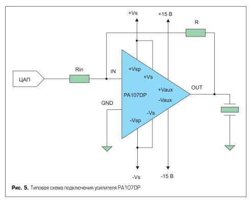
хорошей линейности выходной каскад работает в классе АВ. РА107DP хорошо подходит как для управления пьезопреобразователями в медицинском ультразвуковом оборудовании, так и для изготовления программируемых источников питания, используемых в автоматическом испытательном оборудовании (рис. 5). Микросхемы выпускаются в корпусе PowerSIP, занимающем на печатной плате площадь не более 5 см², для обеспечения SOA необходимо использовать радиатор.
