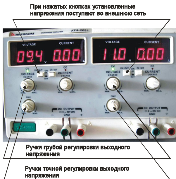
Рис.9. Органы регулировки выходного напряжения
