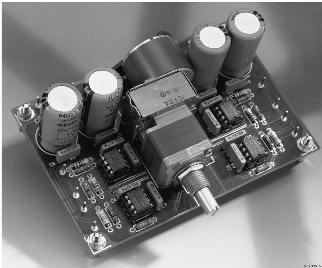
sionnement adopté, de 2,24, de sorte que le gain de chaque canal est de 5. Dans ces conditions la tension Ligne de 200 mV se trouve adaptée à la sensibilité d'entrée de 1 V d'un étage de sortie. Il est bien évidemment possible d'adapter le gain d'ensemble à une valeur différente; il n'en reste pas
