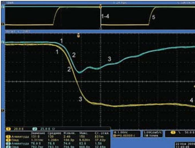
Рис. 7. Осциллограммы импульсов напряжения на коллекторе лавинного транзистора и при сопротивлении нагрузки  $R_n = 50$  Ом релаксатора, изображенного на рис. 4
