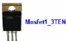
МОП-транзистор (MOSFET) - это полевой транзистор со структурой металл-окисел-полупроводник. В таком транзисторе электрический ток, протекающий через него, управляется индуцированным электрическим полем, создаваемым отрицательным или положительным напряжением, прикладываемым к затвору.
