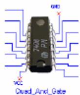
Компонент состоит из четырех независимых двухвходовых логических схем "И".
