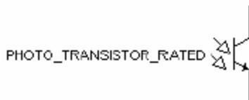
Фототранзистор воспринимает инфракрасный свет, излучаемый фотодиодом. Как правило, эти устройства используются в паре.
