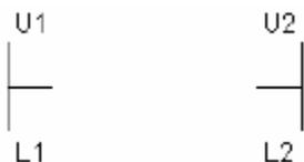
L1 является началом звена (Rung Starter), а L2 – концом звена (Rung Terminator). Если обеспечить требование непрерывности связей между терминаторами начала и конца звена, то на устройства, помещенные в звене, может быть подано питание и их можно активировать.
