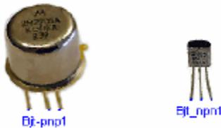
Биполярный транзистор (Bipolar Junction Transistor) – полупроводниковый прибор, управляемый током. Биполярный транзистор работает в трех режимах, определяемых тем, какой элемент является общим для входа и выхода: общая база, общий эмиттер или общий коллектор. Эти режимы отличаются входным и выходным импедансами и коэффициентами усиления, предоставляя различные преимущества для разработчика электронных схем.
