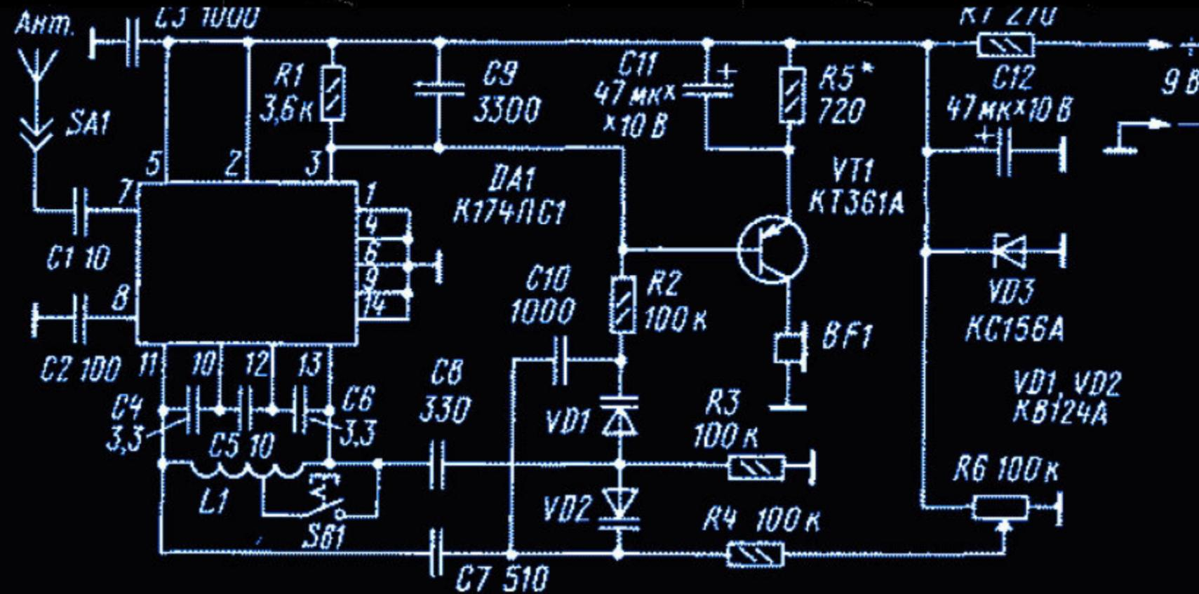
Напряжение питания 5,6 В стабилизировано компонентами R7 и VD3 — это требуется для исключения "ухода" частоты настройки при колебаниях питания. Исходное напряжение не обязательно должно быть 9 В, при другом номинале подбирают R7 так, чтобы общий потребляемый ток схемы был примерно 12 мА.
