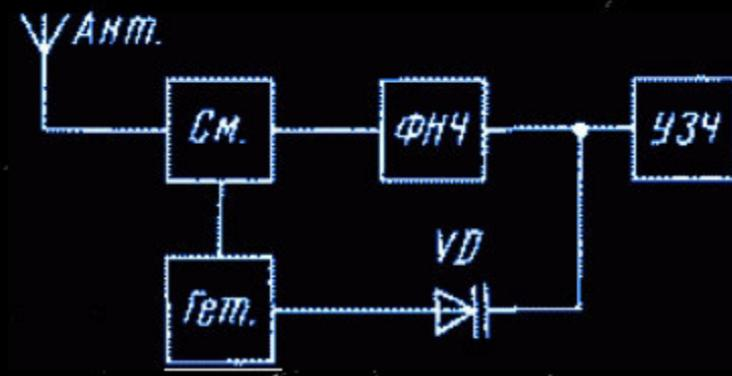
На микросхеме K174ПС1 собраны смеситель и гетеродин. Простейший ФНЧ образован сопротивлением нагрузки R1 и емкостью C9. Варикап управляет частотой гетеродина в зависимости от сигнала обратной связи ФАПЧ, отслеживая частотную модуляцию принимаемого сигнала. Второй варикап VD2 необходим для настройки радиоприемника; напряжение на нем изменяют переменным сопротивлением R6. С помощью SB1 выбирают нужный радиодиапазон: когда контакты разомкнуты 64-75 МГц, когда замкнуты — 85-108 МГц.
