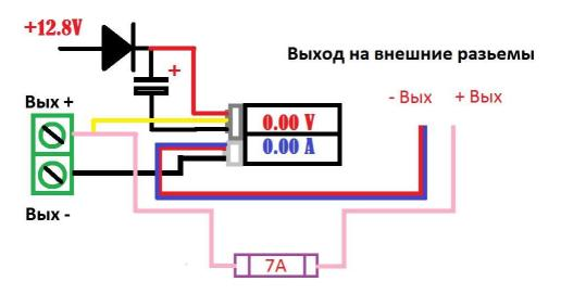
Для подключения вольтамперметра можно использовать приведенную схему подключения. Диод и конденсатор применены для частичной развязки питания измерительного прибора. Данная схема подключения минимизирует влияние на показания прибора.
