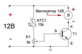
Простейшая схема автоматической регулировки оборотов вентилятора в зависимости от
