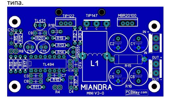
Конструктор спроектирован таким образом, чтоб можно было его собрать даже начинающим радиолюбителям. Для облегчения монтажа радиодеталей не было использовано практически ни одного смд компонента малого размера.
