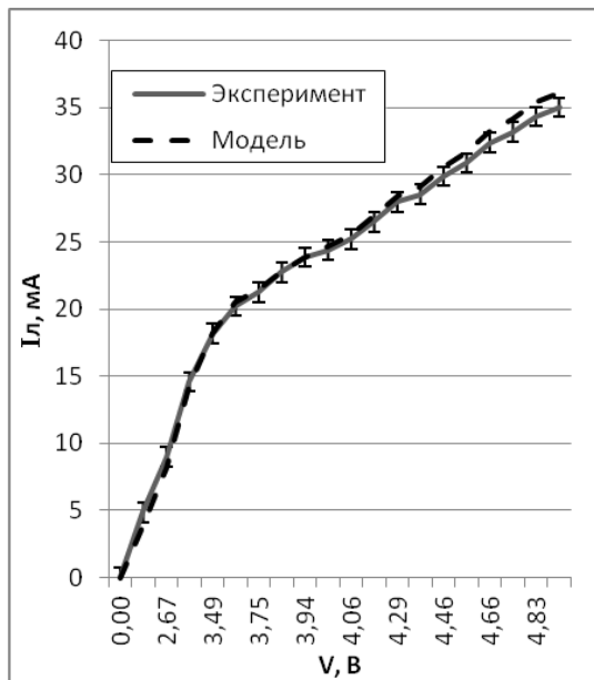
Рисунок 5 – Зависимость тока лазерного диода I_l от напряжения V
