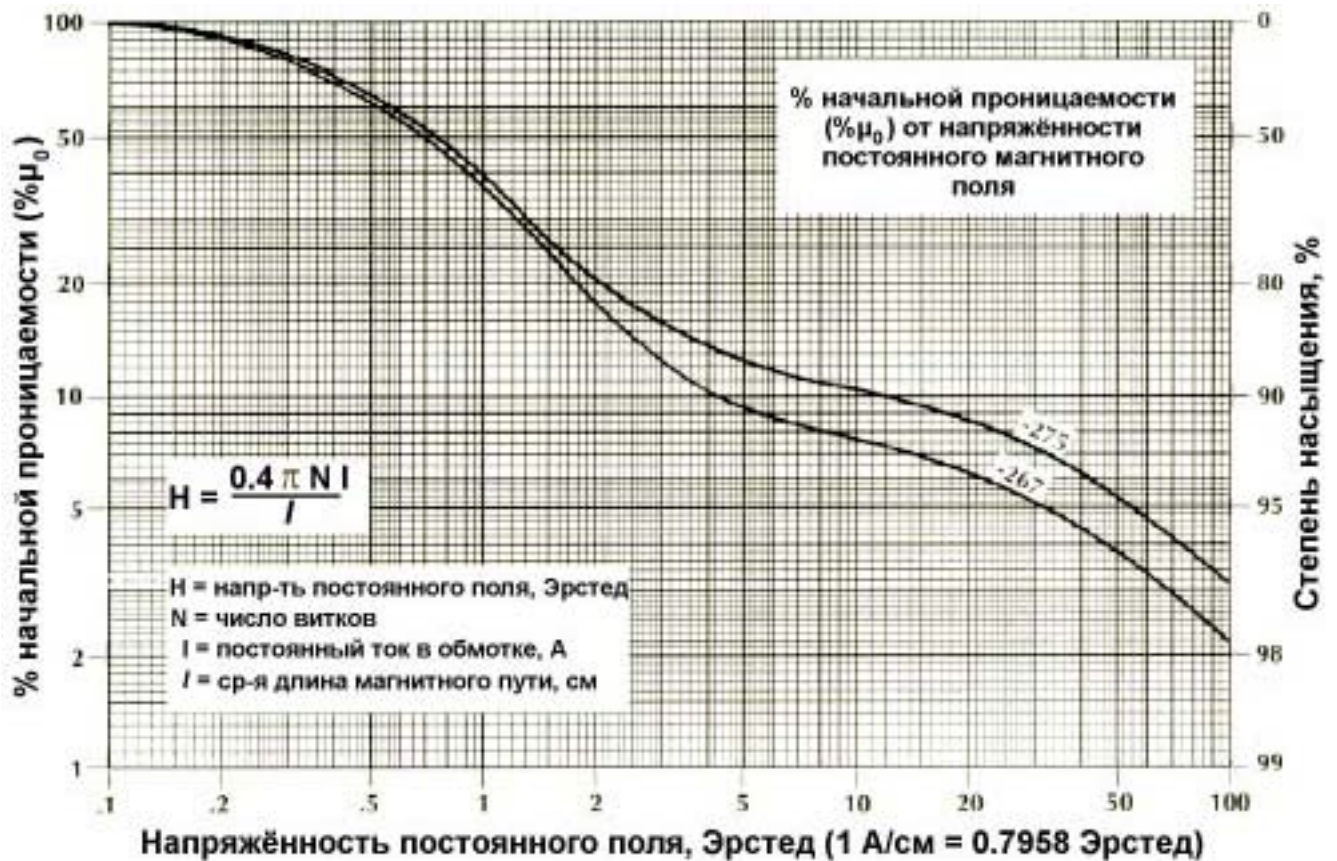
Рисунок 10. Зависимость степени насыщения гибридного сердечника от постоянного тока
