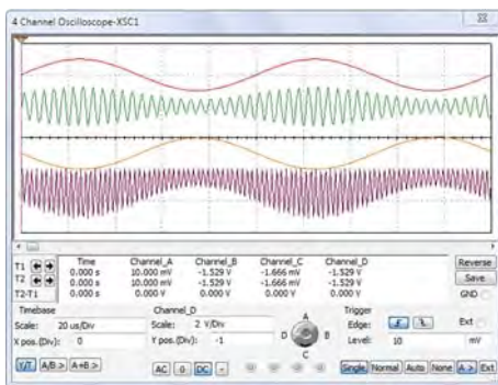
Рис. 10. Сигналы на входе и выходе синхронного демодулятора при совпадении фаз генератора несущего колебания и гетеродина (а) и при фазовом сдвиге между сигналами этих генераторов, равном 90 градусов (б)
