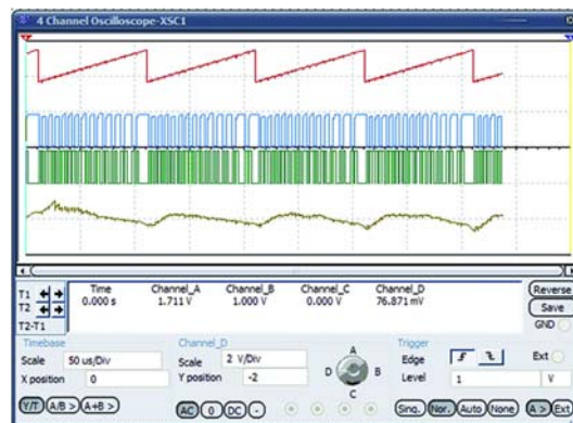
Рис. 12. Результаты проверки линейности характеристики ГУН
