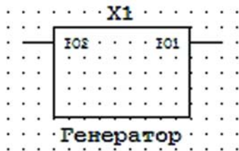
Рис. 4. Изображение подсхемы на рабочем листе после подключения выводов
