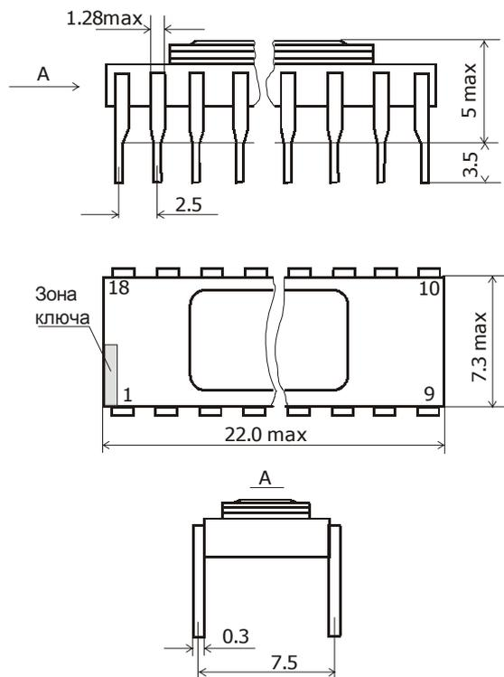
Габаритный чертеж 18-выводного пластмассового корпуса 238.18-3 приведен на последней странице. Номера выводов и их назначение полностью совпадают с корпусом 238.18-1.
