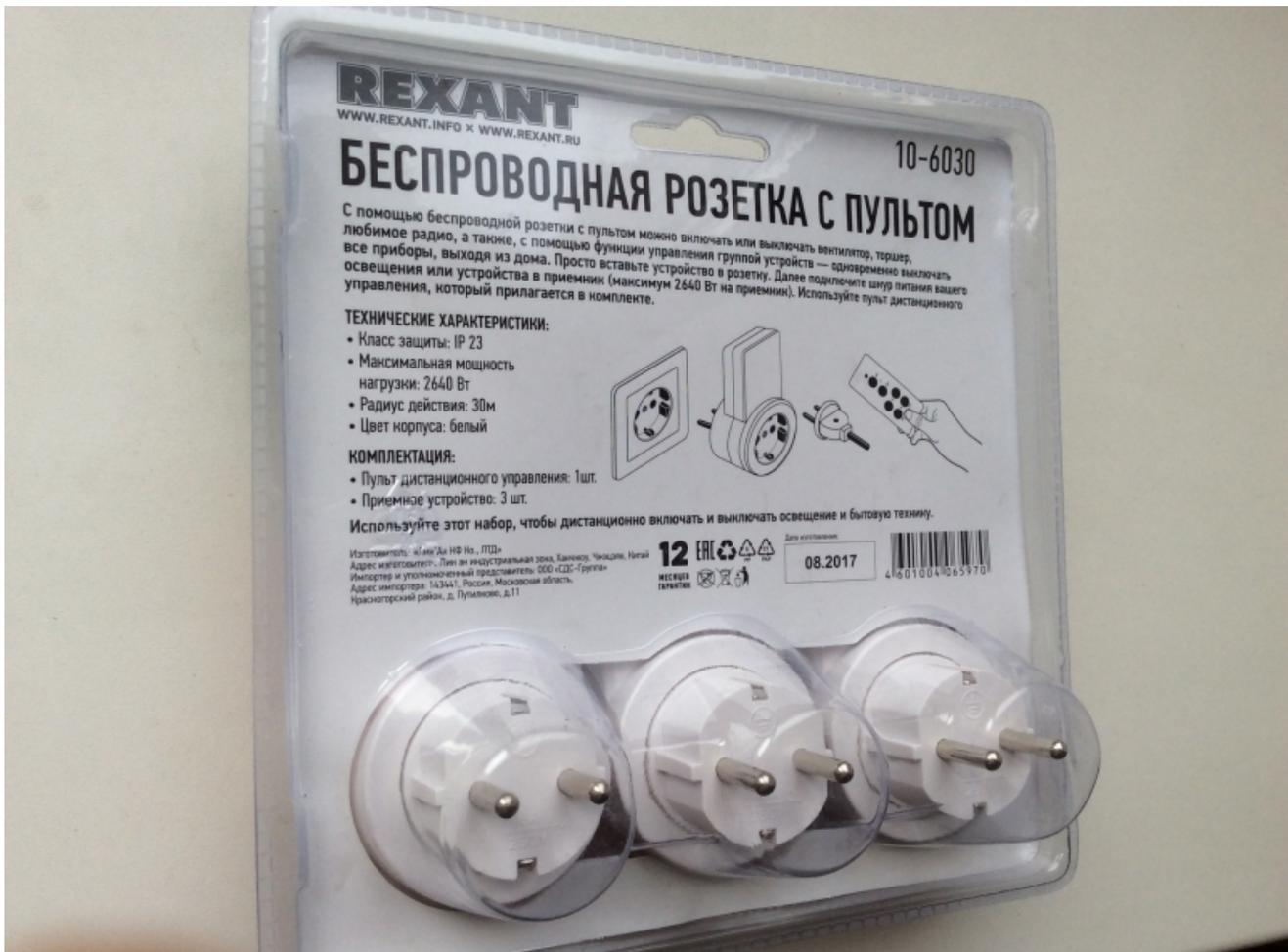
А сейчас подробно расскажу как работает такой радиоуправляемый комплект из трёх розеток с пультом к ним. На этой фотографии на розетке Вы видите цифры, где в данном случае «тройка» после цифр 0305 означает, что она включается левой нижней кнопкой пульта «ON», а выключается кнопкой «OFF». Между ними нарисована цифра «3».
