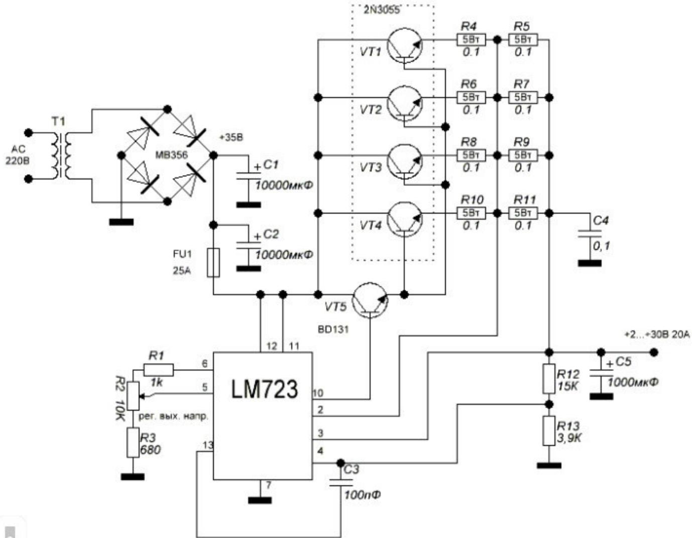
Блок питания состоит из схемы стабилизатора на LM723 и выходного регулятора напряжения на транзисторах VT1-VT5, мощные транзисторы VT2-VT5 которого включены параллельно.
