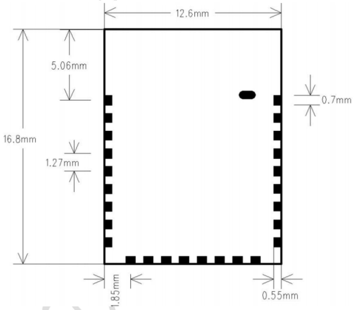
**7.Device pin out diagram:**
