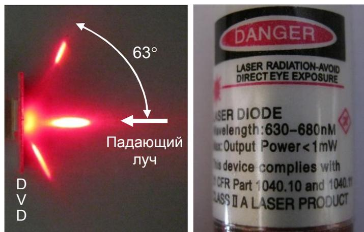
Рисунок 11 – Определение периода решетки на горизонтальном экране при помощи лазерной указки и транспорта (другой более точный способ заключается в том, что на вертикальном экране линейкой измеряется расстояние между максимумами 1-го порядка, а затем угол вычисляется по формулам для прямоугольного треугольника)
