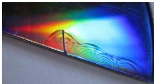
Для изготовления **отражательных дифракционных решеток** наиболее подходят CD-ROM и DVD-ROM, у которых отражательный слой очень прочно соединен с пластмассовой основой и он не удаляется полностью при помощи скотча (рисунок 5).
