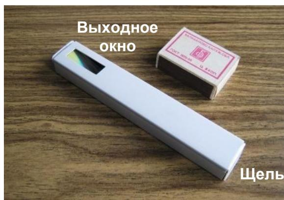
Рисунок 23 – Спектроскоп в кабель-канале (спичечная коробка положена для масштаба)
