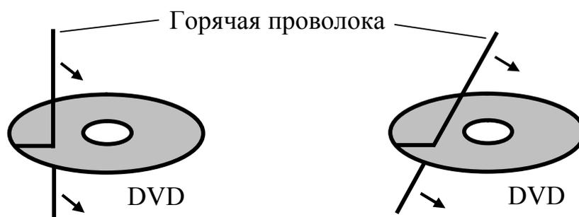
б) два варианта движения горячей проволоки при разрезании диска (стрелками показано направление движения проволоки)
