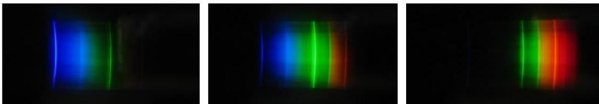
Рисунок 27 – Неравномерная яркость участков спектра, если в спектроскопе узкая входная щель или источник света точечный
