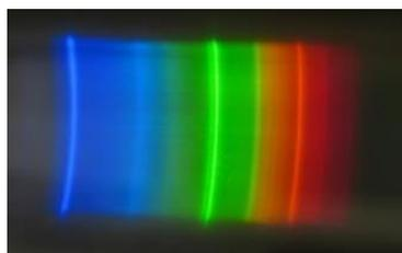
Компактная люминесцентная лампа с улучшенной цветопередачей.
