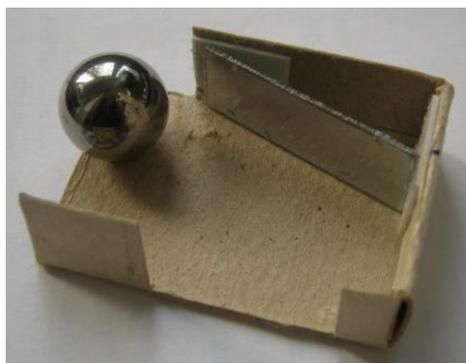
Рисунок 37 – Макет спектрографа со сферическим выпуклым зеркалом
