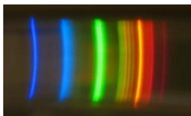
Компактная люминесцентная лампа с линейчатым спектром.
