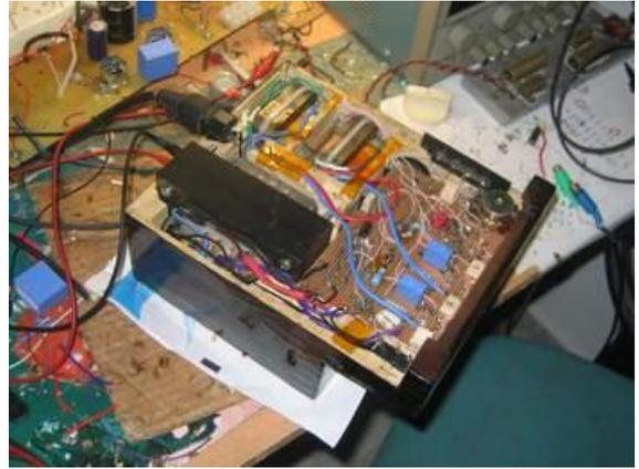
Входные гнезда установлены сбоку, а регулятор громкости и выключатель питания - сверху:
