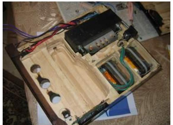
Снаружи дерево протравлено марганцовкой и покрыто бесцветным лаком, внутри - установлена плата усилителя, на задней стенке - разъемы АС, сетевой разъем и предохранитель:
