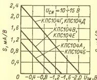
Зависимости крутизны характеристики от напряжения затвор-исток.
