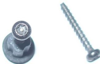
Саморезы корпуса и ножка-заглушка отдельно
