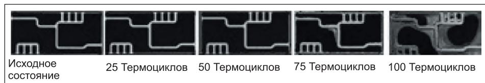
**Рис. 1.** Иллюстрация основного отличия в механизме разрушения подложек HPS9% (ZTA) с металлизацией по технологии DBC по сравнению с подложками из  $\text{Si}_3\text{N}_4$  с металлизацией по технологии AMB после серии термоциклов
