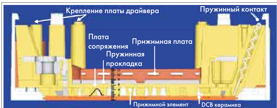
Рис. 2. Поперечный разрез модуля SKiM@5
