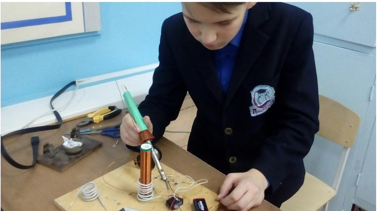
Рис. 2, 3, 4. Сборка катушки Тесла
