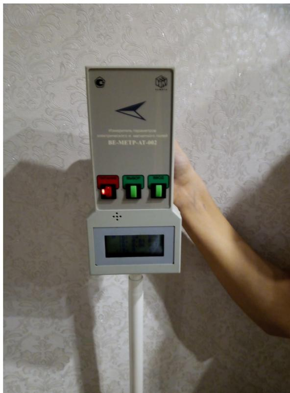
Рис. 6. Прибор «ВЕ-метр-АТ-002»
