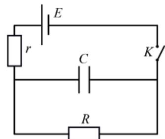
1) Найти максимальный ток  $I_m$  через  $R$  после замыкания ключа.
