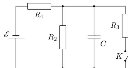
1) Найти ток  $I_0$  через резистор  $R_3$  сразу после замыкания ключа.
