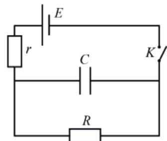
1) Найти максимальный ток  $I_m$  через конденсатор после замыкания ключа.
