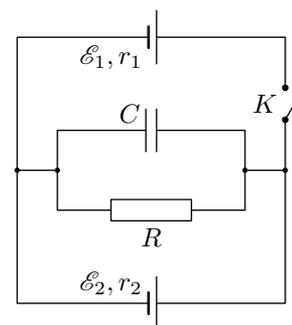
$$I = \left| \frac{\mathcal{E}_1}{R_1} - \frac{\mathcal{E}_2}{r_2} \right| \frac{r_1}{R_1 + r_1} \quad (\text{слева направо})$$
