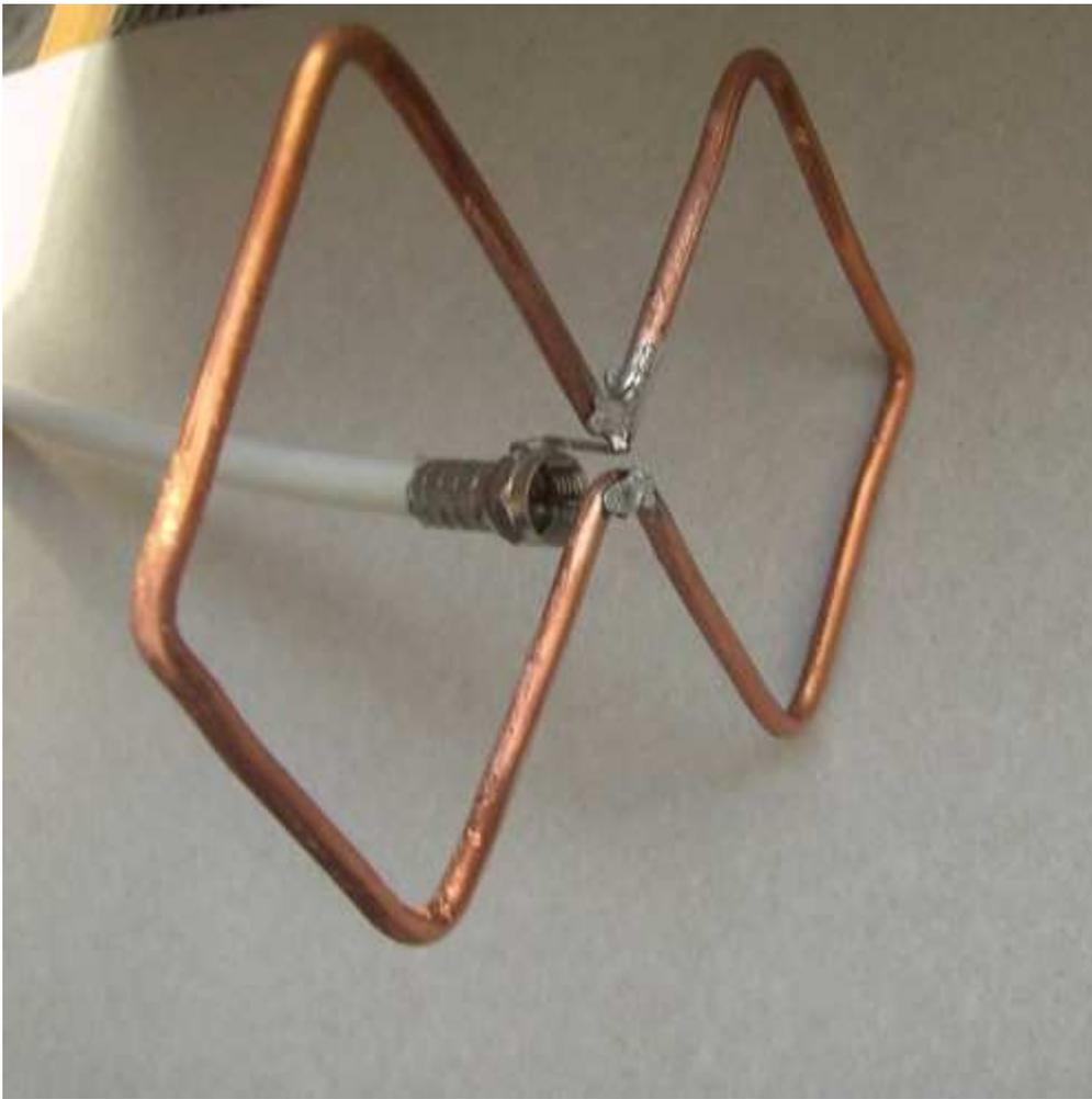
Для повышения эффективности антенну Харченко снабжают рефлектором – металлической пластиной, которую можно изготовить из фольгированного текстолита.
