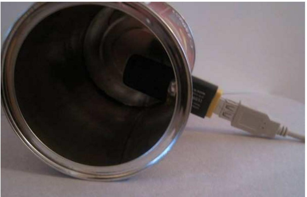
Нужно экспериментально подобрать длину выступающей части близкой нашим расчетам ( $L_0/4 = 36$  мм). Естественно, придется «покружиться» с банкой по дому, чтобы найти место, где уровень сигнала максимален.
