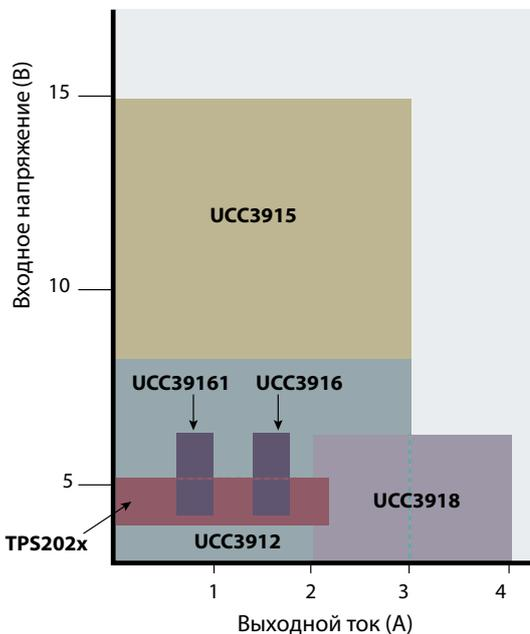
ИС переключения питания в режиме горячей замены (с внешними силовыми полевыми транзисторами)
