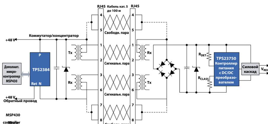
Новые изделия TPS2384 и TPS2375 – ИС управления питанием, соответствующие стандарту IEEE 802,3af, которые разработаны для обеспечения интерфейса между источниками и приемниками питания по сети Ethernet. [www.ti.com/poe](http://www.ti.com/poe)
