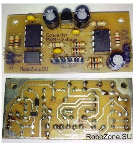
Сделав фотографию с нижней стороны платы и используя программу для обработки изображений, создаем черно-белый рисунок платы и разворачиваем его для получения зеркального изображения. Масштаб рисунка особого значения не имеет, но разрешающая способность должна быть достаточно высокой. Можно использовать и непосредственно фотографию или цветной рисунок, но при этом значительно снизится скорость работы с платой – обработка подвижного цветного изображения займет много времени.
