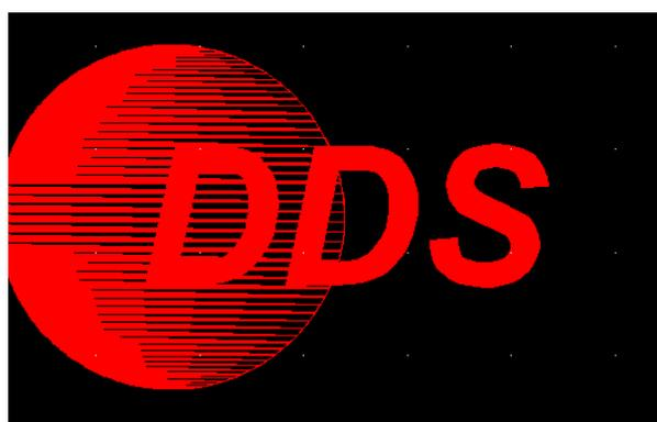
Использование шрифта и картинок допустимо непосредственно в проводящих слоях, но вокруг них обязательно присутствует зазор и, даже при использовании маски, зрительная эффективность надписи уменьшается.
