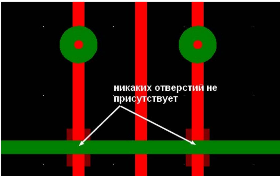
Следующим вспомогательным элементом при создании платы является мостик. Мостик является разновидностью перемычки, но отличается от нее своими свойствами. Во-первых, он относится не к проводникам, а к компонентам и имеет определенные размеры и хранится в библиотеке компонентов. Во-вторых, он предназначен для соединения двух
