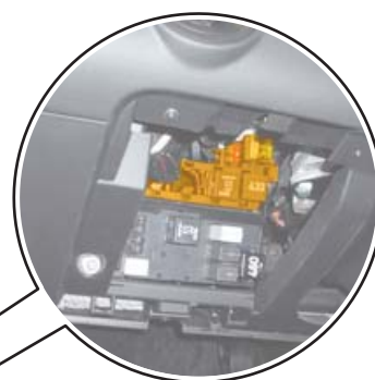
Блок реле под панелью приборов слева, над блоком управления бортовой сетью
