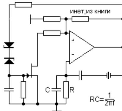
**90.Гармонический генератор с регулировкой частоты.**
