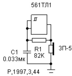
**25. RC генератор на триггере Шмидта с изменяемой скважностью.**
