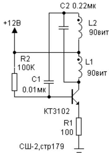
**49. LC генератор на последовательном контуре/**
