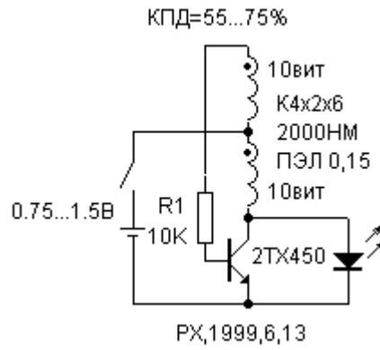
**63.Металлоискатель.Сигнал принимается на средневолновый приёмник.**
