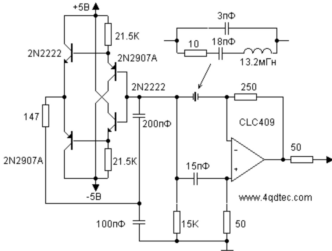
101. Генератор с отдельной регулировкой частоты и длительности импульсов.
