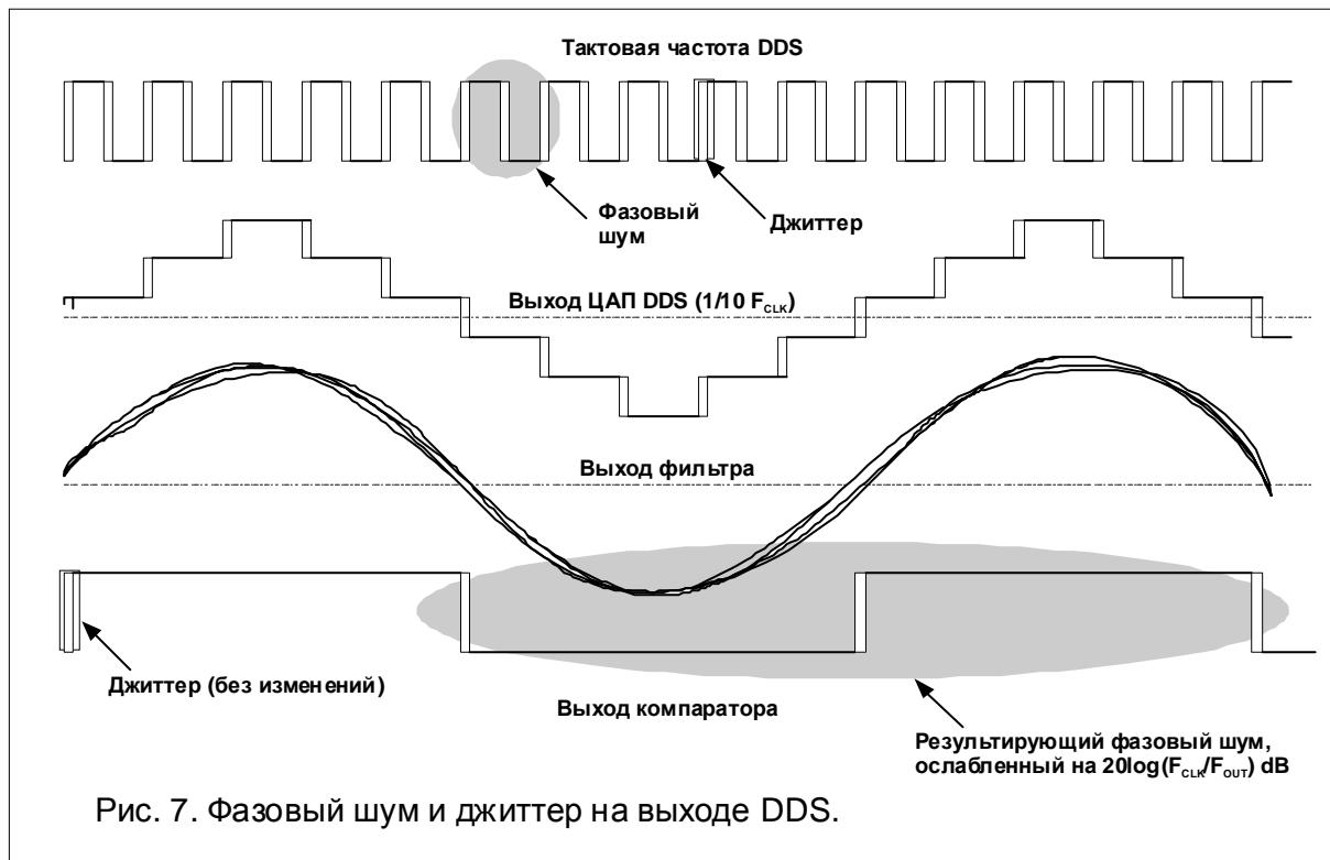
Рис. 7. Фазовый шум и джиттер на выходе DDS.
