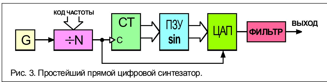
Рис. 3. Простейший прямой цифровой синтезатор.
