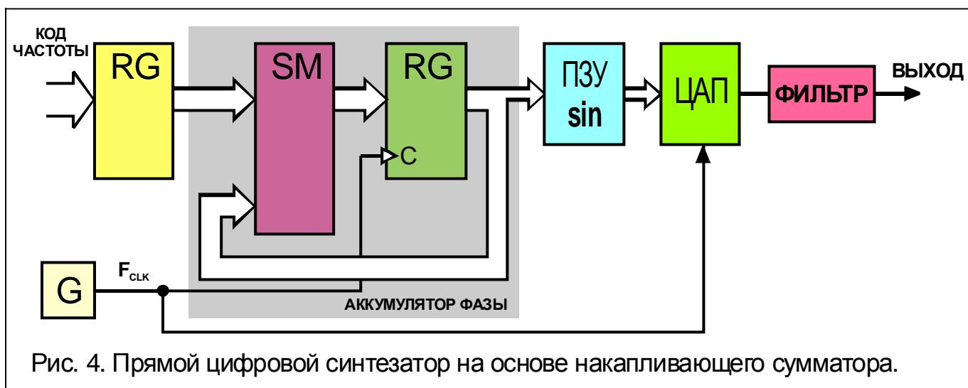
Рис. 4. Прямой цифровой синтезатор на основе накапливающего сумматора.
