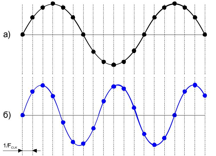
Рис. 6. Положения выборок выходного сигнала для разных частот.
