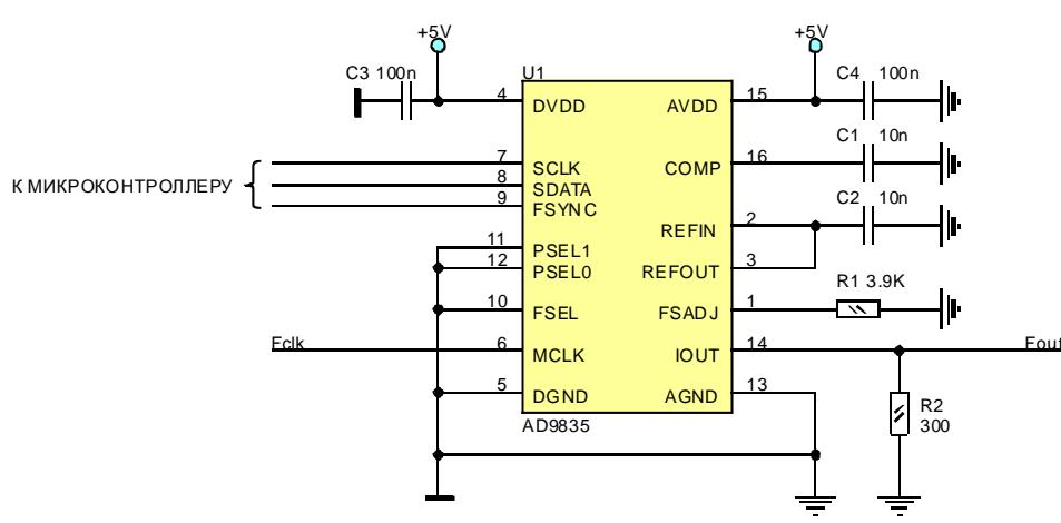
Рис. 22. Схема включения DDS AD9835.
