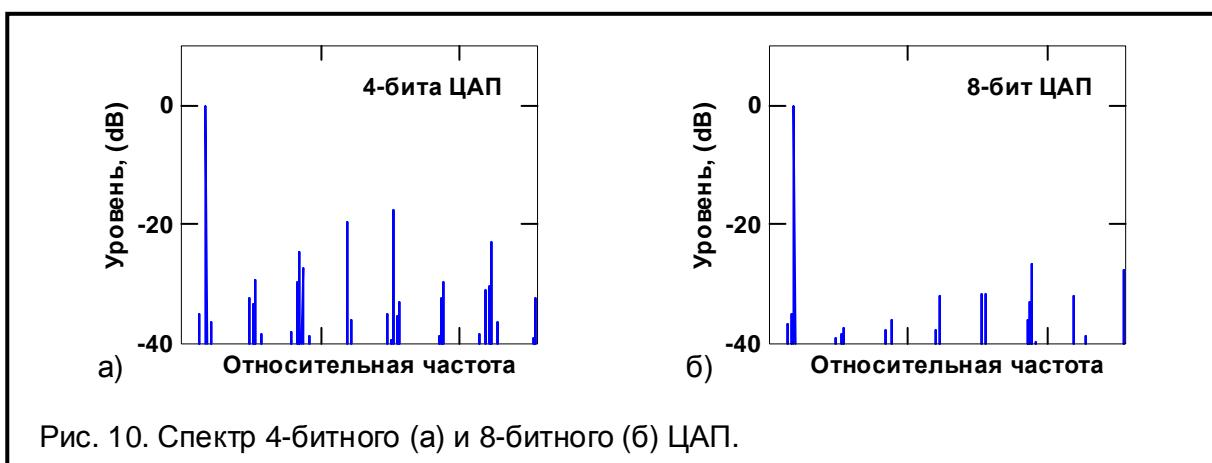
Рис. 10. Спектр 4-битного (а) и 8-битного (б) ЦАП.
