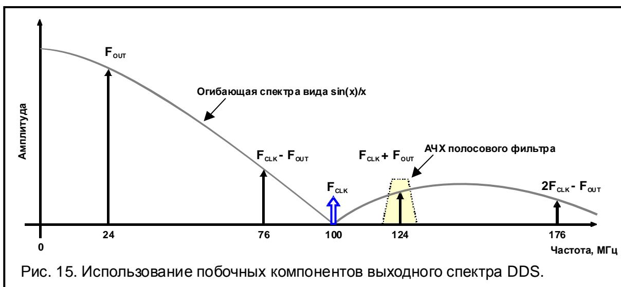
Рис. 15. Использование побочных компонентов выходного спектра DDS.
