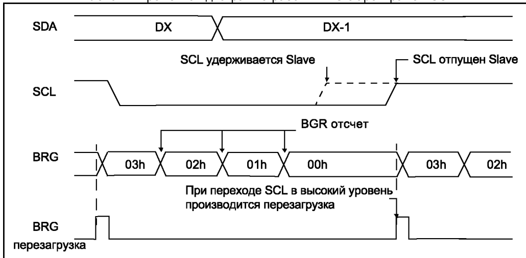
Рис. 9-11 Временная диаграмма работы BRG с арбитражем SCL
