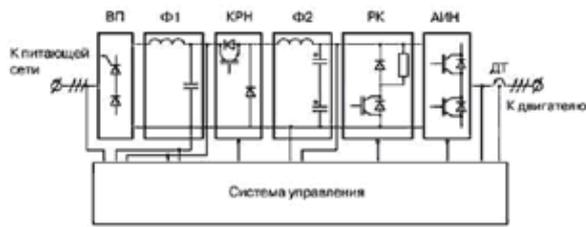
Рис. 7. Функциональная схема силовой части электрического преобразователя БДПТ
