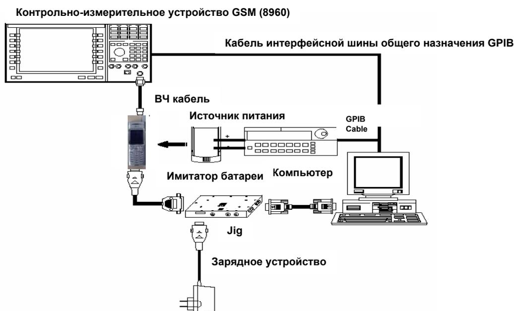
Рис. 7-1. Оборудование для выполнения калибровки
