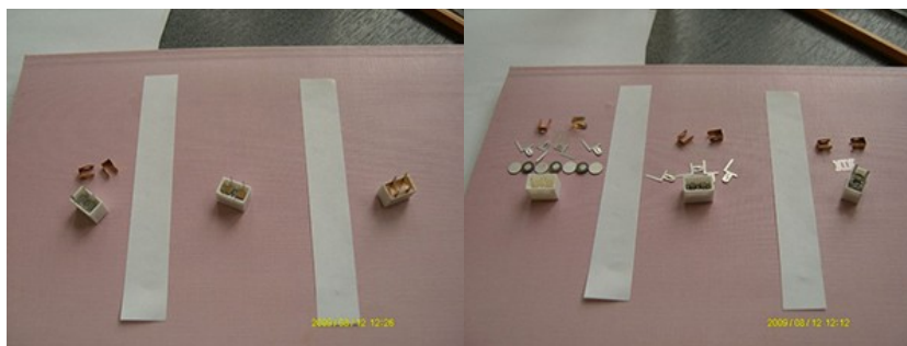
Рис.8. Устройство и последовательность сборки пьезокерамического фильтра ФП1П1-60.
