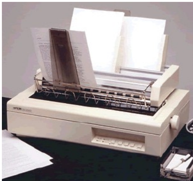
Первый струйный принтер Epson с пьезоэлементами - SQ-2000.
