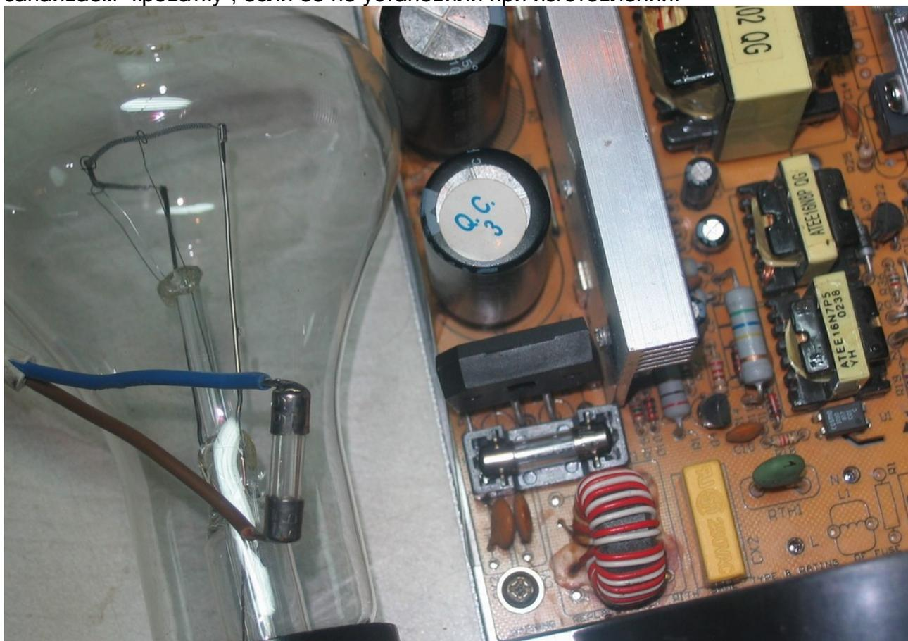
5. Вместо предохранителя вставляем в "кроватку" заранее подготовленный резистор изготовленный из сгоревшего предохранителя и лампочки на 220 Вольт мощностью 100-200 Ватт.
