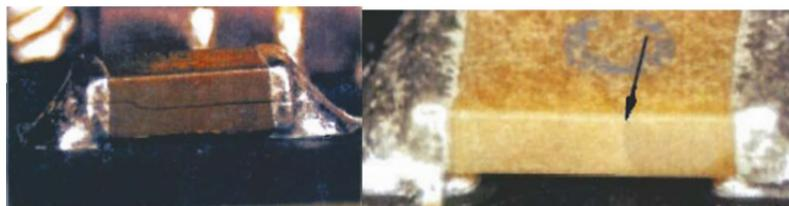
*Рис. 21. Механическое повреждение чип-компонента*
