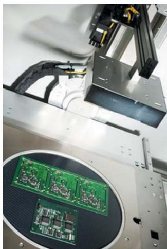
*Рис. 2. Поворотный стол и плоский цифровой детектор*
