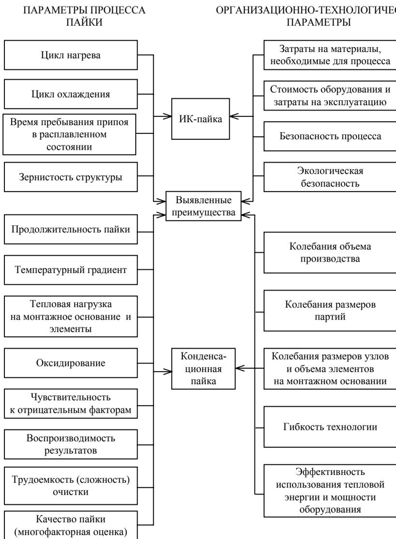
Рис. 11.1. Результаты сравнительного анализа методов пайки при поверхностном монтаже
