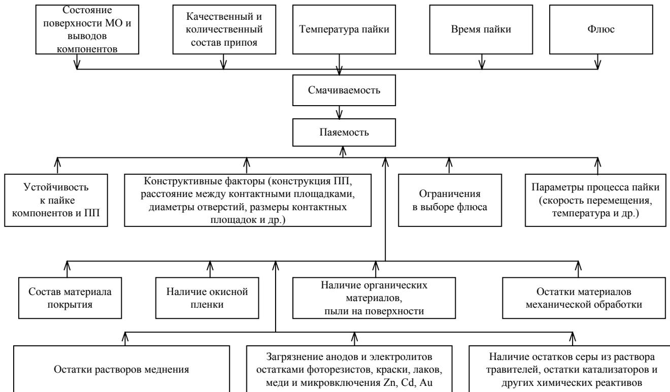
Рис. 5.2. Факторы, определяющие смачиваемость и паяемость монтажного основания
