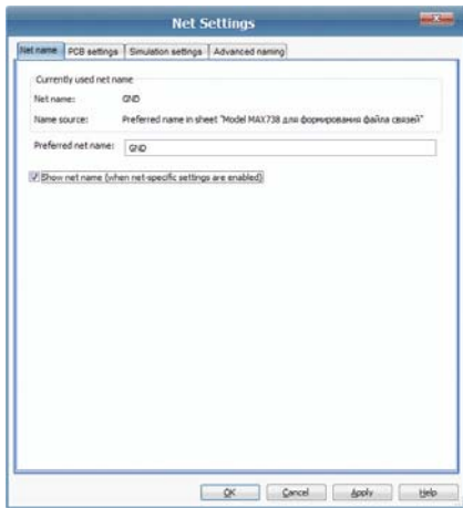
Рис. 5. Формирование имени общего провода в окне Net Settings
