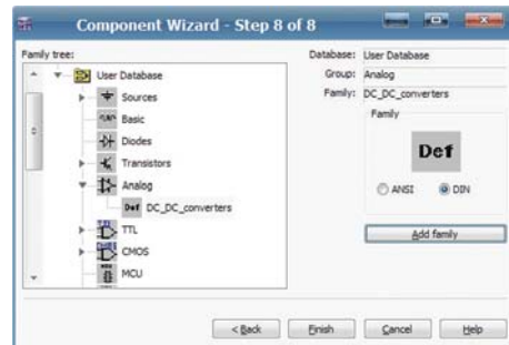
Рис. 14. Окно формирования элемента библиотеки Multisim – шаг 8 (сохранение созданного элемента в пользовательской базе данных)
