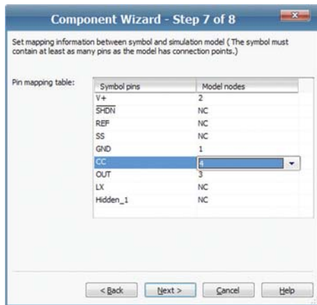
Рис. 13. Окно формирования элемента библиотеки Multisim – шаг 7 (редактирование номеров нод)
