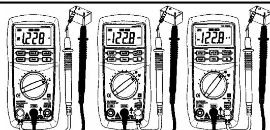
4.11.1 Вставьте штекер черного щупа в гнездо "COM", а красного в гнездо "INPUT", если измеряемый ток не будет превышать 200 мА. В противном случае вставьте штекер красного щупа в гнездо "10A".
