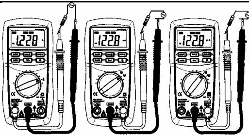
4.12.1 Вставьте штекер черного щупа в гнездо "COM", а красного в гнездо "INPUT", если измеряемый ток не будет превышать 200 мА. В противном случае вставьте штекер красного щупа в гнездо "10A".
