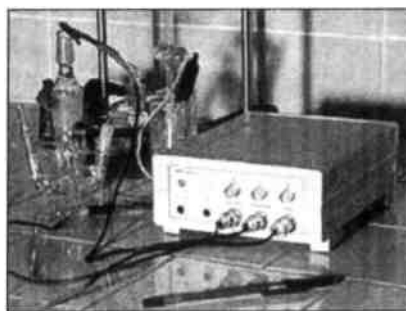
Рис. 2.1 Внешний вид потенциостата - гальваностата IPC-Compact.
