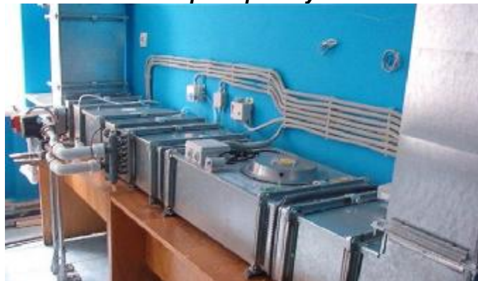
Стенд для испытаний канальной приточной установки (REMAK)
