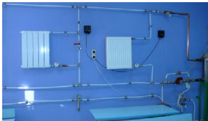
Стенд для исследования работы системы отопления из металлопластиковых и медных труб
